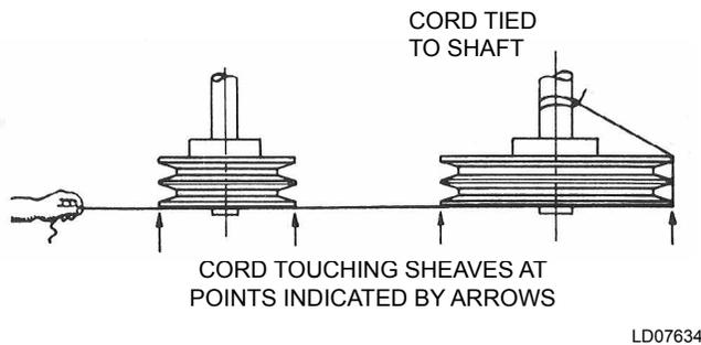
**FIGURE 21 - SHEAVE ALIGNMENT**
