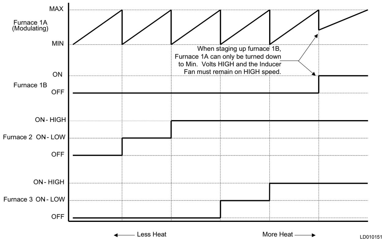
**FIGURE 41 - MODULATING GAS HEAT STAGING SEQUENCE**
